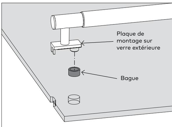
2.3.2 Placer la bague sur la plaque de montage extérieure sur verre.
