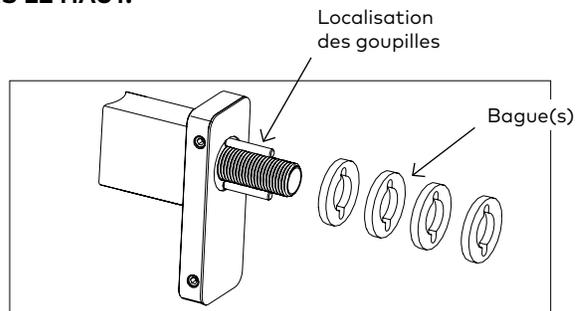
2.6.1 Glisser la ou les bague(s) de l'actionneur sur les goupilles de positionnement de la plaque de montage.
