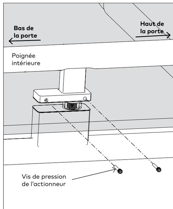
2.6.3 Fixer le montant de l'actionneur factice à la plaque de montage avec les deux vis de pression fournies.
