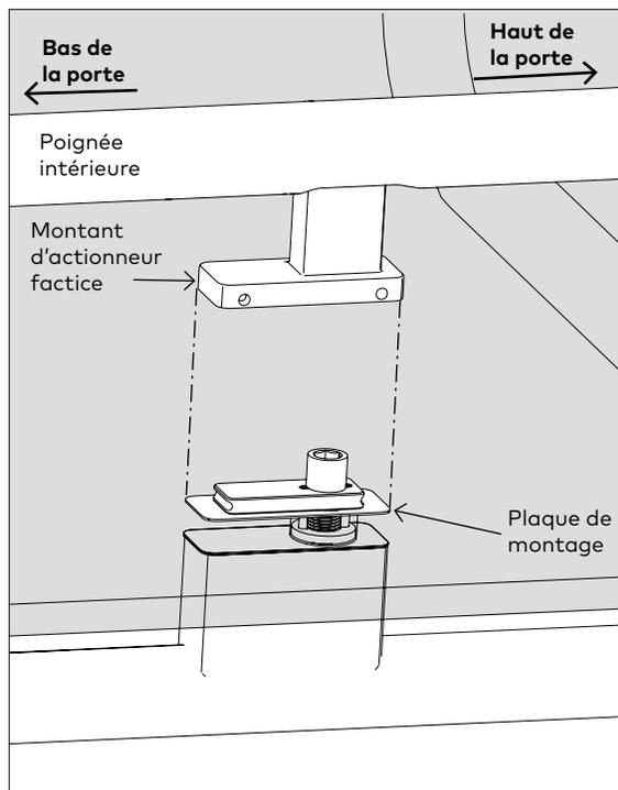
2.6.2 Placer le montant de l'actionneur factice sur le dessus de la plaque de montage.
