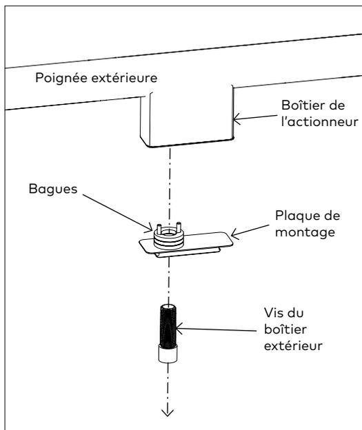
**REMARQUE : Le produit est livré avec la vis du boîtier extérieur et la plaque de montage fixées ensemble.**
