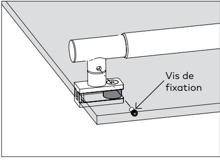
2.7.2 Fixer le tube intérieur à la plaque de montage intérieure sur verre à l'aide de la vis de fixation.
